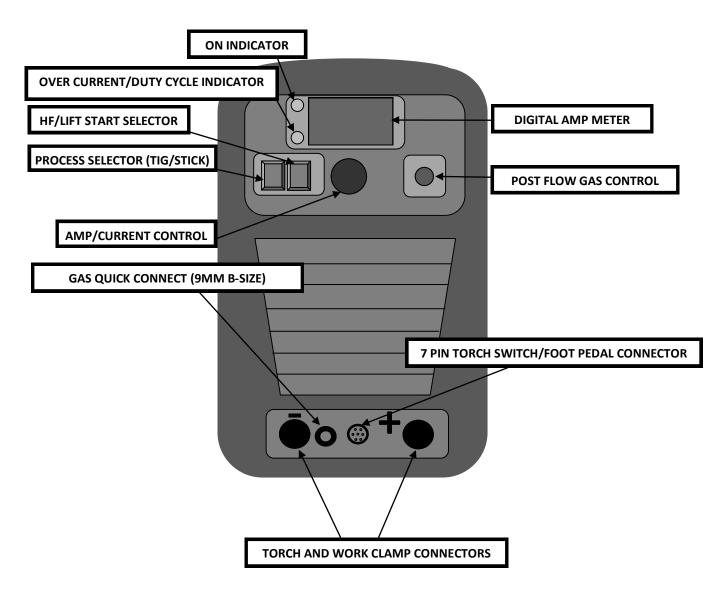
*POLARITY:* TIG MODE: TORCH NEGATIVE (-), WORK POSITIVE (+) STICK MODE: TORCH POSITIVE (+), WORK NEGATIVE (-)
