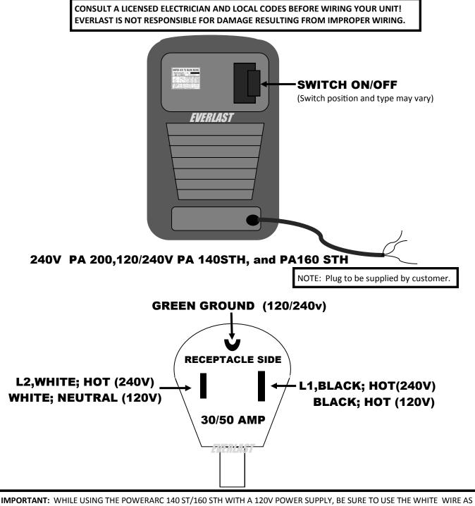
THE COMMON/NEUTRAL, THE BLACK AS THE HOT, AND THE GREEN AS THE GROUND OR MALFUNCTION/DAMAGE MAY OCCUR.
